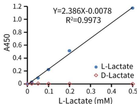
图2. 碧云天L-乳酸检测试剂盒(WST-8法) (S0208)检测L-乳酸标准品的标准曲线。实际检测数据会因实验条件、检测仪器等的不同而存在差异，图中数据仅供参考。
